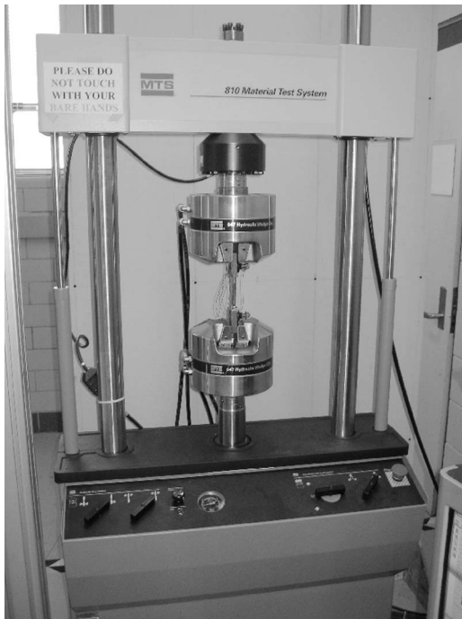
Fig. 4 Fatigue test setup
